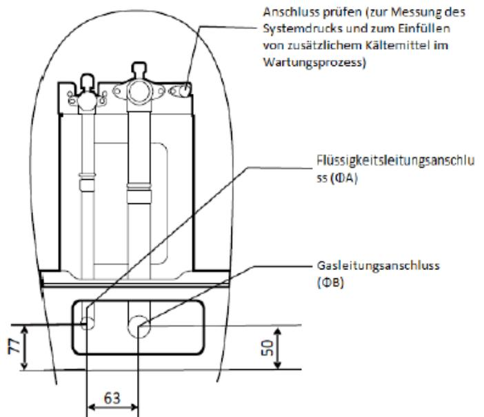
Anschlussrohrdurchmesser (Einheit: mm)
