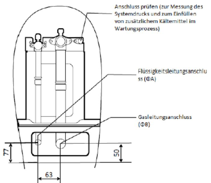
Anschlussrohrdurchmesser (Einheit: mm)
