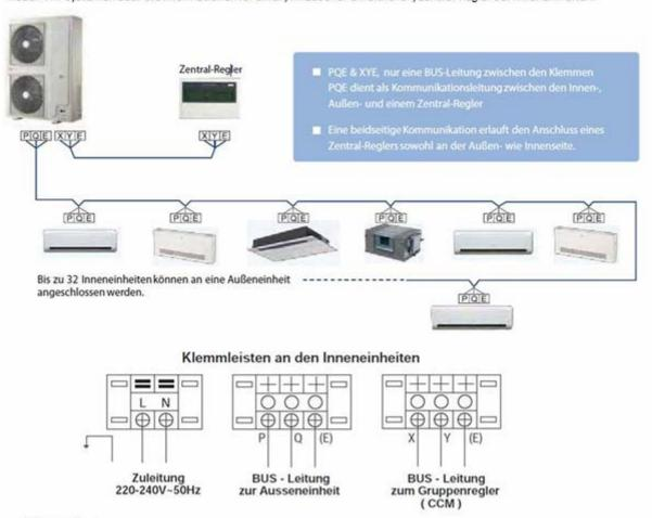
Hinweis: Spannungsversorgung und Busleitungen sind separat zu verlegen!
